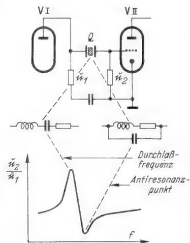
Bild 1. Grundsätzliche Anordnung und Übertragungscharakteristik eines Quarzfilters
