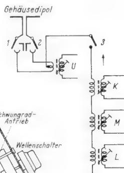
Bild 5. Antennenumschaltung (Telefunken)
