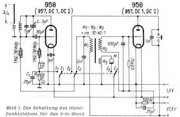
Bild 1. Die Schaltung des Handfunktelefons für das 2-m-Band
