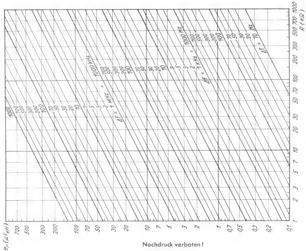
Bild 3. Diagramm zur Berechnung der Rausch-EMK aus gegebenem Widerstand  $R$  ( $k\Omega$ ) und gegebener Bandbreite  $\Delta f$ .
