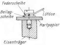
Bild 2. Lötösen sollen mit dem Schraubenkopf oder mit der Mutter guten Kontakt herstellen
