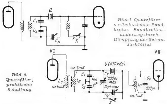
Bild 8. Quarzfilter; praktische Schaltung
