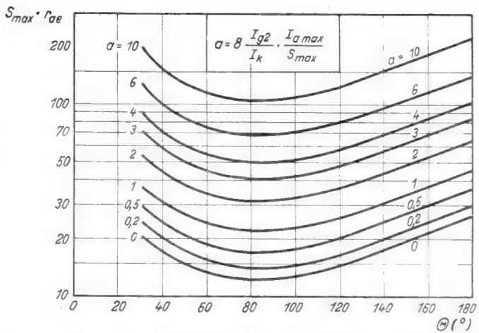
Bild 9. Diagramm zur Bestimmung des äquivalenten Rauschwertes bei additiver Mischschaltung
