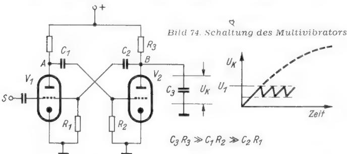
Schwierigkeiten Frequenzen von wenigen Hertz bis zu mehreren hundert Kilohertz erzeugen. Dieser Frequenzbereich kann allerdings nicht allein durch Verändern der Schirmgitterspannung der Aufladeröhre V bestrichen werden, sondern man muß mehrere Frequenzbereiche schaffen, die man in einfacher Weise durch umschaltbare Kippkondensatoren erhält. Wir wollen darauf jedoch nicht weiter eingehen.
