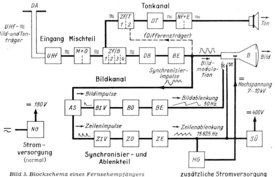
Bild 3. Blockschema eines Fernsehempfängers
