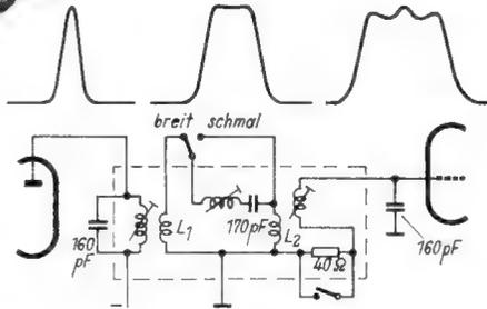
klasse (Trioxor, Novum und Neos 52) die Dreifach-Flankendemodulation angewandt. Das benutzte Schaltungsprinzip geht von der Tatsache aus, daß die FM-Demodulation an einem frequenzabhängigen Widerstand im Anodenkreis einer Röhre erfolgen kann und die als Amplitudenmodulation erwünschte Spannungsschwankung wesentlich größer ausfällt, wenn man als Anodenwiderstand an Stelle einer
