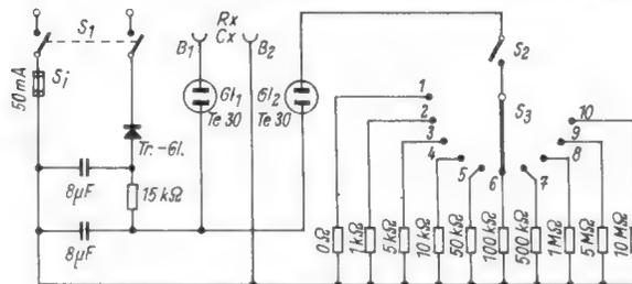
nen, unbekanntes Widerstandes zu ermitteln. Der unbekanntes Widerstand wird mit den Prüfbuchsen verbunden. Nach Einschalten des Schalters S<sub>2</sub> schaltet man den Stufenschalter S<sub>3</sub> so lange von einem Bereich zum anderen, bis die Glimm-
